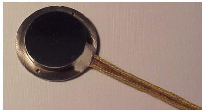
PHT-50型 半導体方式平板金属型熱流計で通過熱流を直接測定できるセンサーで約1000°Cまで測定できます。
