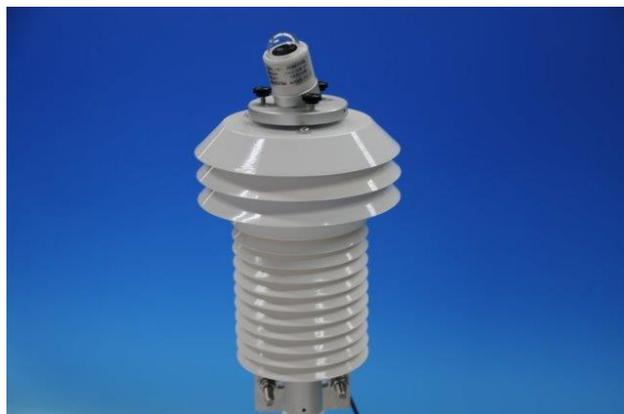
この通風筒は温度計用の強制通風型通風筒と日射計を一体化した構造で、温度計部は周囲にアルミ製白塗装の放射シールドを設け日射からの温度上昇を防ぎ、又モーターファンを上部に内蔵することで強制的に空気を通風させています。オプションで太陽電池による無電源運転が可能です。
