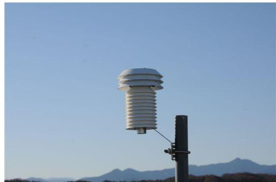
この通風筒は温度計用の強制通風型通風筒で、周囲にアルミ製白塗装の放射シールドを設け日射からの温度上昇を防ぎ、又モーターファンを上部に内蔵することで強制的に空気を通風させています。構造を簡単にし軽量化しています。オプションで太陽電池による無電源運転が可能です。
